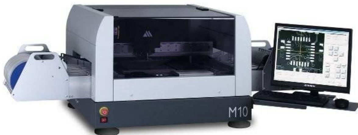
M10 – универсальный автомат для установки компонентов поверхностного монтажа от 0201 до 30x30 мм, с функцией видео-центрирования компонентов.
