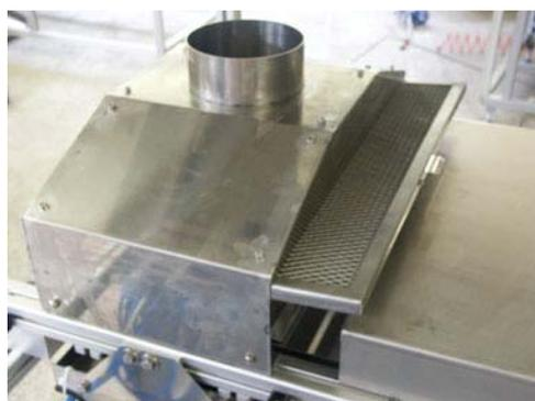
Все пары флюсователя сразу же попадают в систему вытяжки расположенную над флюсователем (кожух из нержавеющей стали), система оснащена быстро съемными фильтрами, что позволяет их обслуживать без особого труда.
