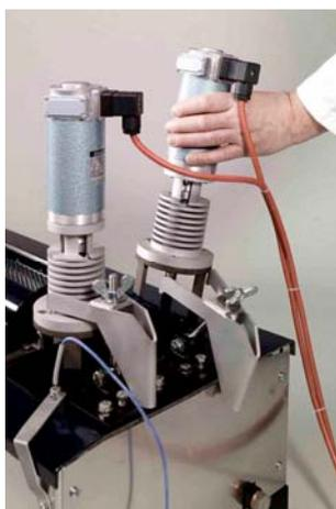
Для более простого обслуживания фирмой ATF была разработана специальная система быстрого съема нагнетательных помп ванны припоя.
