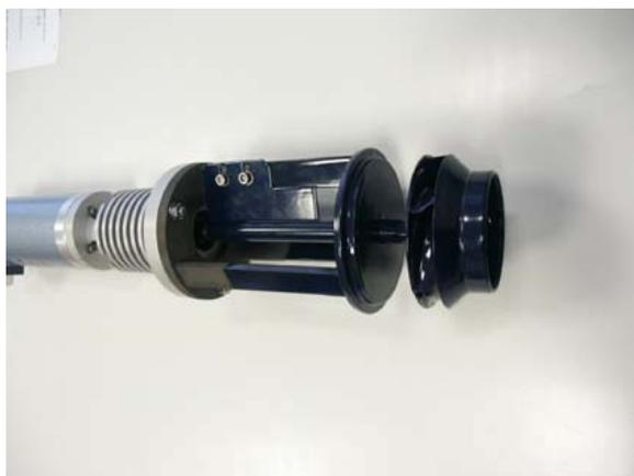
Для решения вопроса использования двух ванн припоя (например, использование свинцовой и бессвинцовой технологии) у фирмы ATF существует решение использование взаимозаменяемой ванны припоя. Для удобства и быстрой смены ванны можно приобрести отдельно специальные приспособления, такие как устройство выкатывания ванны, подъемный лифт.
