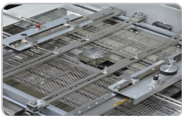
Универсальная регулируемая поддержка больших печатных плат
