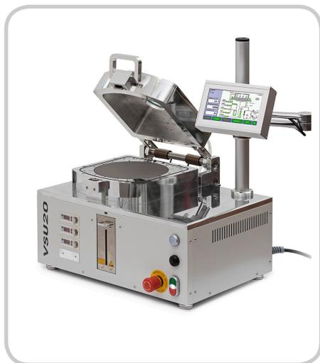
Вакуумная печь VSU20 оборудована алюминиевой нагревательной плитой с керамическим покрытием. Охлаждающая плита расположена под нагревательной. Охлаждение осуществляется с помощью рециркуляции воды. Охлаждающая плита плотно прижимается к нагревательной плите и таким образом достигается высокая скорость охлаждения. Эта функция может быть также использована для охлаждения в вакууме.
