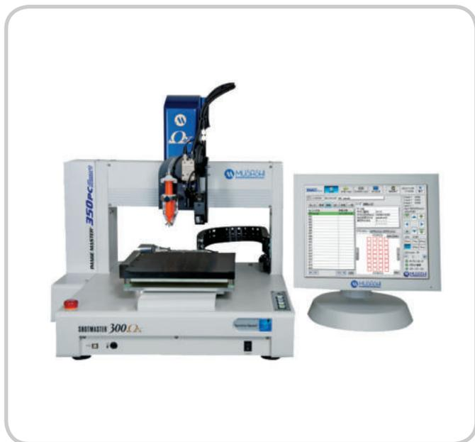
Серия полуавтоматических установок дозирования Image Master 350PC Smart построена на комбинации настольных роботов серии Shotmaster SM OmegaX и системы машинного зрения, включающей видеосистему, лазерный датчик измерения высот, управляющий компьютер и программное обеспечение MuCAD™V.
