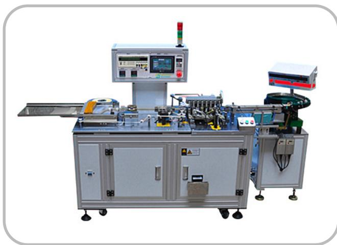
Упаковщик компонентов в ленту S-U500 позволяет паковать в ленту следующие типы выводных компонентов: электролитические конденсаторы, тонкопленочные конденсаторы, светодиоды, транзисторы и другие компоненты. При упаковке автоматически формируются выводы. На выходе лент подготовлена для упаковки в коробку. Управление упаковщиком осуществляется при помощи тачскрина. Программное обеспечение просто в освоении и легко позволяет установить необходимые параметры упаковки.
