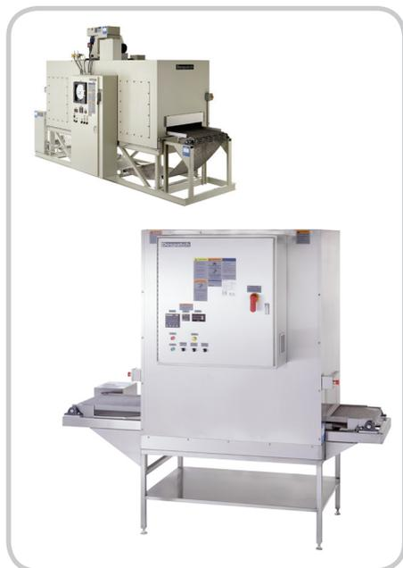
Сушильные шкафы конвейерного типа предназначены для термообработки большого количества изделий одинакового типа. Высокая степень температурной однородности внутри рабочей камеры достигается за счет создания мощного вертикального потока нагретого воздуха, подаваемого сверху вниз.
