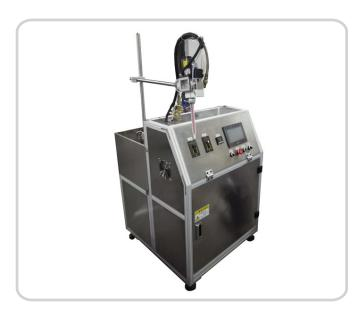
Установка предназначена для смешивания и дозирования компаундов для герметизации узлов электронной техники, заливки корпусов, блоков питания LED модулей и т.п.
