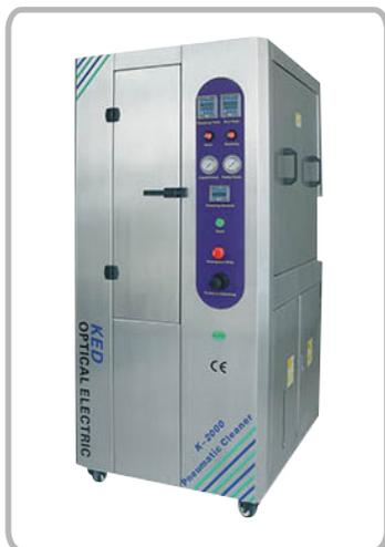
Система пневматической очистки трафаретов Ked предназначена для отмывки паяльной пасты, клея, и других материалов после пайки. За счет использования сжатого воздуха система безопасна в работе с легко воспламеняющимися веществами.
