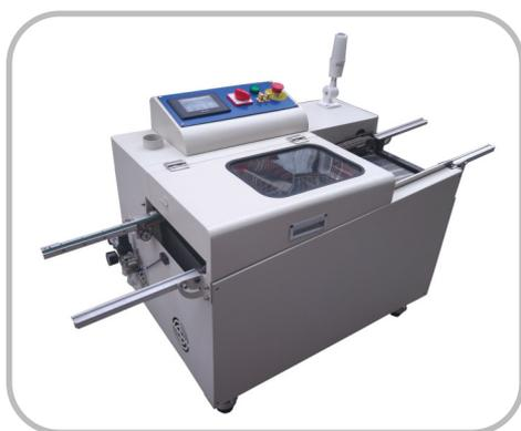
Компактная настольная машина предназначена для пайки выводных компонентов двойной волной припоя на платах размером до 200 x 200 мм. Оснащена цепным конвейером, пенным флюсователем и модулем инфракрасного преднагрева. Ванна для припоя вместимостью до 50 кг и паяльные сопла изготовлены из высококачественной нержавеющей стали и опционально могут быть заменены на титановые. Управление системой осуществляется с помощью ПЛК с сенсорным экраном. Система проста в эксплуатации и обслуживании.
