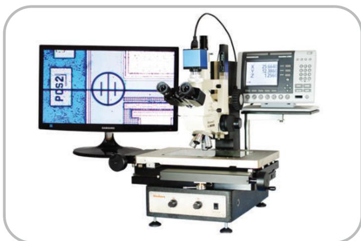
HISOMET2-DH2 это измерительная система, обладающая возможностью высокоточной фокусировки, благодаря встроенным в оптическую систему микроскопа светоделительной призмы и окулярной сетки, выполняющей роль фокусной метки, которая проецируется на поверхность образца. Даже при незначительной расфокусировке фокусная метка отображается разделенной на две части. И только в состоянии фокуса на поверхности образца, верхняя и нижняя части фокусной метки полностью совмещаются друг с другом.
