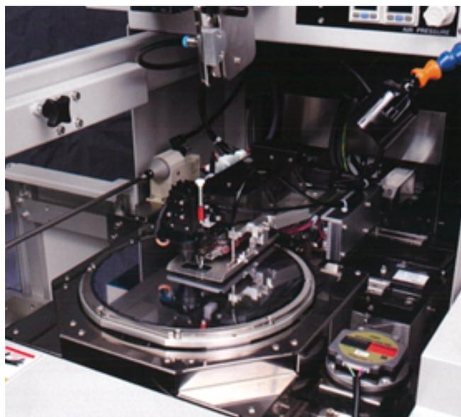
Установка FB-996 Bump II предназначена для высокоскоростного бампирования полупроводниковых пластин методом термозвуковой приварки шариков из золотой, медной или серебряной проволоки (Stud Bumping). Установка позволяет создавать до 30 бампов в секунду на пластинах диаметром до 200 мм.
