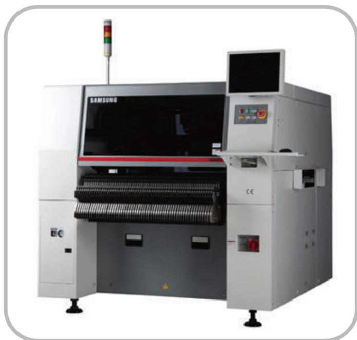
Самый универсальный автомат в серии SM. SM482Plus оснащен всем необходимым для работы с любыми типами компонентов. Инспекция компонентов прямо в движении, позволяет ставить микросхемы размером до 14мм на скорости в 30 000 компонентов в час, а фиксированные камеры позволяют работать с до 55мм и коннекторами до 75 мм.
