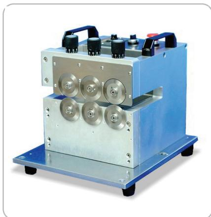
Моторизованный сепаратор предназначен для разделения предварительно скрайбированных печатных плат в электронной промышленности
