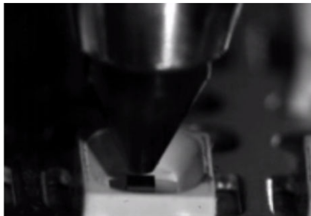
Монтаж кристалла в корпус светодиода
