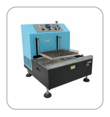
Установка предназначена для групповой пайки выводных компонентов методом погружения в расплавленный припой.
