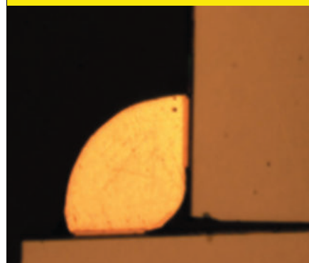
Шлиф паяного соединения вертикально смонтированного кристалла
