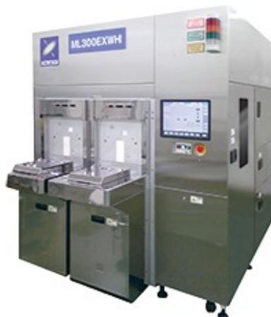
ML300EX WH – установка лазерной резки пластин диаметром до 300 мм. Загрузка и разгрузка пластин выполняется автоматически из магазина в магазин.
