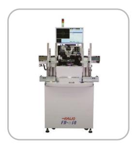
Установка FB-e18 предназначена для высокоскоростной разварки кристаллов дискретных компонентов и светодиодов. В базовой комплектации установка оборудована двух-частотным ультразвуковым преобразователем.
