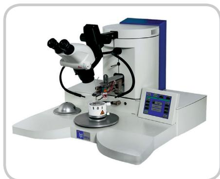
Установки ТРТ HB10 являются полуавтоматами и используются для клиновой микросварки и термокомпрессионной сварки золотым шариком. Сварка проводится с помощью тонкой проволоки (до 75 микрон) из золота, алюминия, серебра и меди, а также с помощью ленты шириной до 250 микрон.
