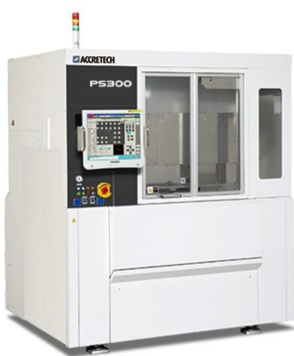
**PS300** – автоматическая, отдельно стоящая установка разделения групповых заготовок (выводных рамок) полупроводниковых компонентов методом дисковой резки. Установка оснащена двумя независимыми рабочими столами, что позволяет увеличить производительность за счет параллельного выполнения операций по загрузке/выгрузке, резке и автоматическому совмещению заготовки и режущего диска.
