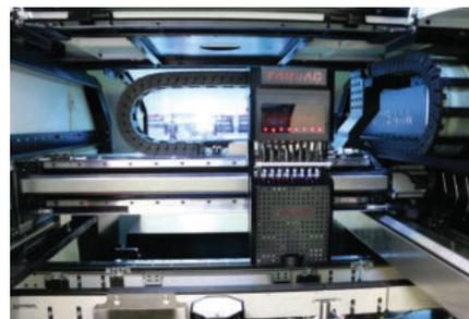
Скорость работы установщиков Fagood обеспечивается при помощи камеры линейного сканирования и 8 монтажных голов на СРМ-II (16 на СРМ-III). Скорость достигает 26 000 компонентов в час для СРМ-II и 65 000 компонентов в час для СРМ-III. Также имеется возможность автоматической смены насадок, что позволяет работать с широкой номенклатурой и не тратить лишнее время на переоснастку установщика под другое изделие.
