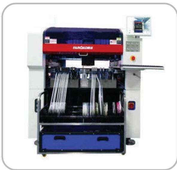
Автоматические установщики СРМ-II и СРМ-III компании Fagood являются универсальными системами на основе высокоточных линейных двигателей. Отлично подходят для среднесерийного производства. Благодаря высокоточной монтажной голове, позволяют собирать сложные, технологичные изделия.
