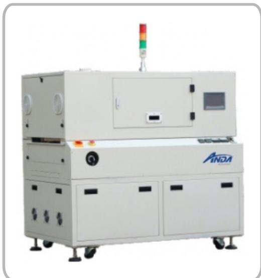
Печи iCure-2UV и iCure-2UV+Plus предназначены для УФ отверждения защитных и клеящих материалов. Оснащены трехзонным конвейером (цепной пальцевый, опционально: двухпоточный для плат шириной до 220 мм и возвратный в нижнем ярусе). Модели оборудованы PLC-контроллером для управления интенсивностью излучения и скоростью конвейера. Обе УФ-лампы находятся в верхней зоне. В модели iCure-2UV+Plus есть управляемая система охлаждения.
