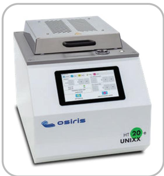
Лабораторный термостол UNIXX HT20e применяется для сушки и задубливания фоторезиста на полупроводниковых пластинах диаметром до 200 мм или подложках размером 200 x 200 мм. Для удобства при загрузке и разгрузке пластин термостол оснащен подъемными штифтами, приводимыми в движение электроприводом.
