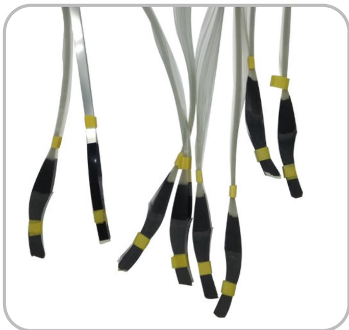
Заправочные концы используются в работе с неполными катушками и обрезками лент. Они служат для зарядки покровной ленты в питатель во избежание потерь компонентов. Без этих приспособлений оператору, чтобы нарастить ленту на катушке, нужно найти место на покровной ленте для удлинения, затем приклеить на него склейку.
