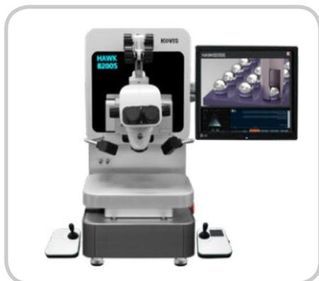
Установка HAWK-8200S представляет собой тестер, предназначенный для выполнения различных тестов по измерению механической прочности соединений на производстве изделий микроэлектроники: сдвиг кристаллов или шариков сварных соединений, отрыв сварных соединений, сдвиг или на отрыв бампов и пр. Установка универсальна – она оснащается сменными картриджами, предназначенными для выполнения разных тестов.
