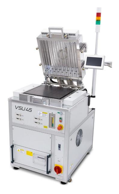
Печь вакуумной пайки VSU45 позволяет выполнять пайку в среде азота, парах муравьиной кислоты и других защитных средах. Возможно использование встроенного источника плазмы низкого давления для очистки и активации поверхности перед пайкой.
