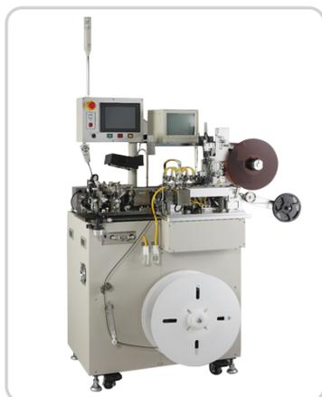
Установка NCT-5100 это высокоскоростной упаковщик электронных компонентов (например, светодиодов) в блистерную ленту шириной 8, 12 или 16 мм. Перед упаковкой выполняется проверка электрических характеристик компонента. Если измеренные характеристики не соответствуют заданному диапазону, то такой компонент отбраковывается и не упаковывается в ленту.
