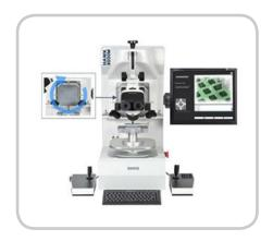
Установка HAWK-8000M предназначена для выполнения различных тестов по измерению механической прочности соединений на производстве изделий микроэлектроники: сдвиг кристаллов или шариков сварных соединений, отрыв сварных соединений, сдвиг или на отрыв бампов и пр. Многофункциональность установки обеспечивается за счет того, что она оснащена поворотным механизмом, на который можно установить до 4 картриджей, предназначенных для выполнения разных тестов.
