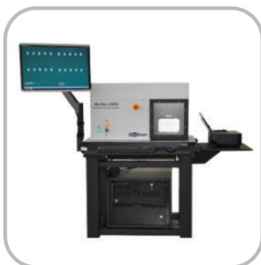
Автоматическая установка NorCom 2020 используется при работе с электронными изделиями ответственных применений, для которых важна герметичность. За один цикл NorCom 2020 осуществляет поиск высокой точности больших и малых течей. Данная установка является полноценной системой контроля герметичности. В комплектацию входят: рабочий компьютер, антивибрационный стол, струйный принтер, монитор 24". Запатентованный лазерный интерферометр одновременно инспектирует сборки на большие и малые течи.
