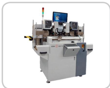
Автоматическая двухголовочная установка разварки кристаллов толстой алюминиевой проволокой предназначена для производства мощных полупроводниковых дискретных компонентов и модулей.
