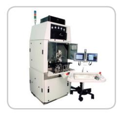
Установка Palomar 6500 предназначена для выполнения полностью автоматической высокоскоростной прецизионной сборки микроэлектронных устройств с точностью до 1,5 мкм. Монтаж компонентов может производиться на клей или с использованием эвтектической пайки. Длительность одной технологической операции составляет 7 секунд.
