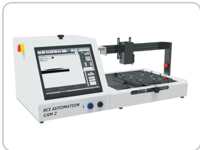
Установка CAM-2 является настольной и предназначена для проведения лабораторных исследований и тестовых измерений, с целью определения адгезионных свойств. Типовым применением является определение технологического режима при плазменной обработке.
