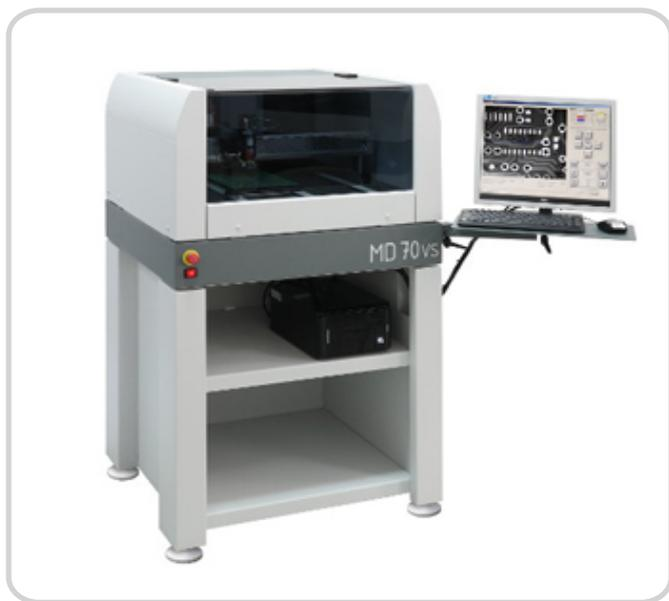
Автоматический дозатор MD70VS осуществляет нанесение паяльной пасты на печатную плату. Устройство используется на небольших производственных участках. Оператору необходимо заменить плату и запустить программу, дальнейший процесс происходит автоматически.
