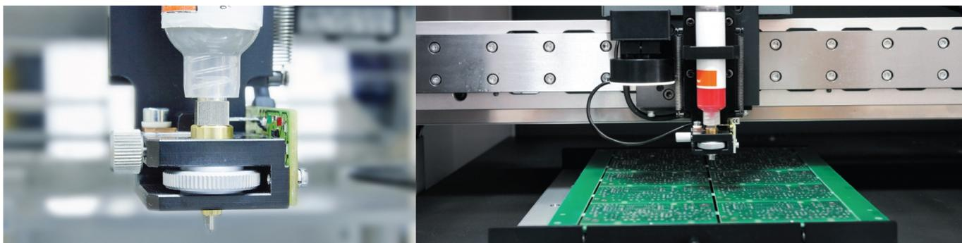
В основе приводов по осям X и Y установлены микрошаговые двигатели и линейные магнитные энкодеры, обеспечивающие точность позиционирования головы в 5 микрон. В большинстве случаев подобный принцип встречается только у дорогостоящего технологического оборудования.
