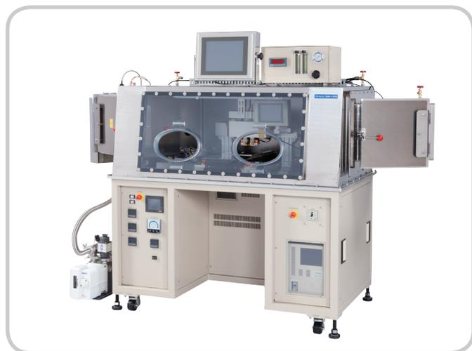
Полуавтоматическая установка NAW-1105/2020 предназначена для герметизации корпусов методом шовно-роликовой сварки. Герметизация производится в герметичном перчаточном скафандре в азотной среде.
