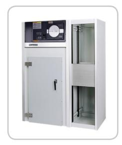
Шкафы PBC и PNC используются для электротермотренировки полупроводниковых компонентов (микросхем, RAM, ROM, микропроцессоров и пр.) при прямом и обратном смещении, электротермотренировки в динамическом и статическом режимах.
