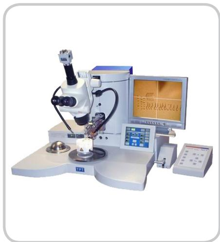
Серия полуавтоматических установок ТРТ HB16 предназначена для клиновой микросварки и термокомпрессионной сварки золотым шариком. Сварка производится тонкой проволокой (до 75 микрон) из золота, алюминия, серебра и меди, а также лентой шириной до 250 микрон. В отличие от серии HB10, установки серии HB16 обеспечивают моторизованное перемещение инструмента не только по оси Z, но и по оси Y, что дает возможность получать повторяемые петли сложной формы или выполнять стежковую сварку.
