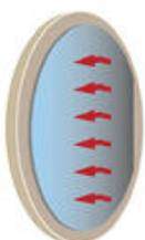
3. Снятие за счет плоскопараллельного смещения пластины вдоль носителя
