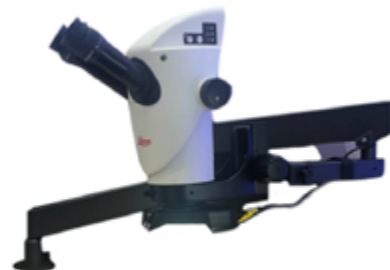
Универсальный штатив пантографической конструкции
