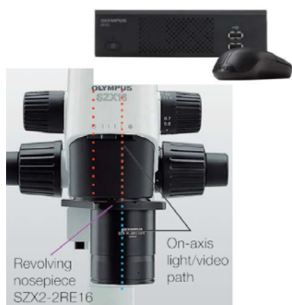
Коаксиальное положение объектива
