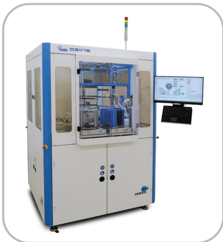
VARIXX 804 – это полностью автоматизированный кластер, предназначенный для нанесения, сушки, проявления и задубливания фоторезистов. Кластер состоит из четырех модулей, объединенных в единую автоматизированную платформу, управляемую встроенным программным обеспечением. VARIXX 804 позволяет обрабатывать пластины диаметром до 200 мм или прямоугольные подложки размером до 150x150 мм.
