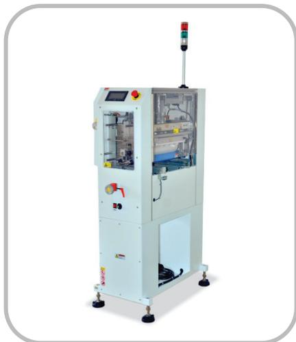
Конвейер предназначен для удаления частиц стекловолокна, пыль и иных загрязнений с поверхности печатной платы. Благодаря компактным размерам - всего 550 мм - конвейер может быть легко встроен в начало линии поверхностного монтажа перед принтером для нанесения пасты. Система очистки включает в себя ESD щётку, подачу сжатого воздуха с ионизатором и адгезивный ролик. Опционально возможна очистка поверхности с обеих сторон.
