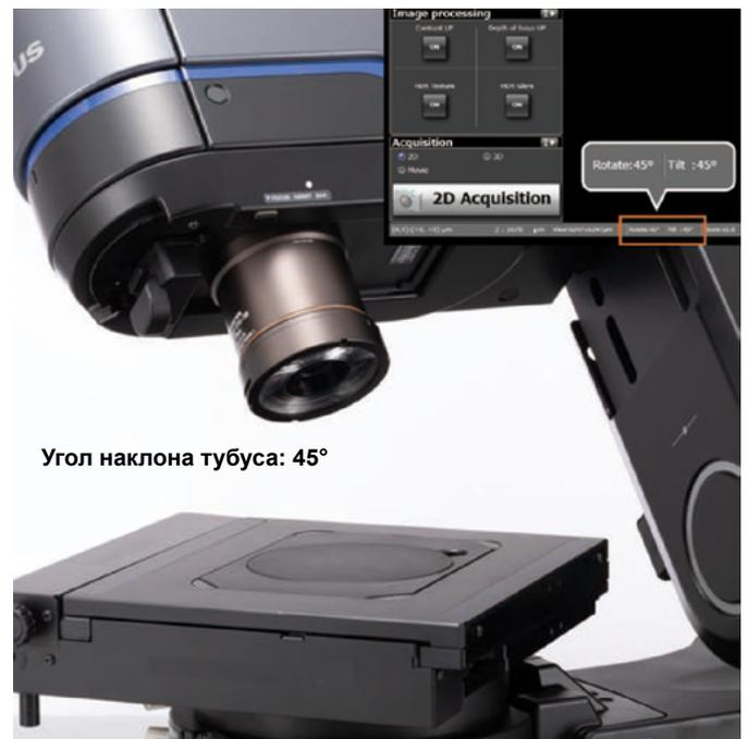
Датчик угла наклона
