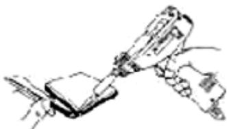
Расплавление припоя для удаления PLCC горячим обдувом.
