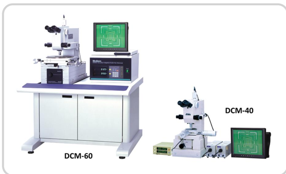
Микроскопы DCM-40/60 предназначены для сравнения рисунков топологии на лицевой и обратной стороне полупроводниковой пластины. Сравнение выполняется путем наложения изображений обеих сторон пластины в одном поле зрения (как правило, с выводом на экран монитора). Таким образом могут быть легко обнаружены любые несоответствия между рисунками топологии и измерено рассовмещение слоев друг относительно друга.
