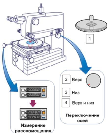
1. Включить обе оптические оси (верх и низ). Совместить оптические оси верхнего и нижнего объективов с помощью калибровочной сетки
