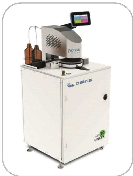
Установка UNIXX INK20 предназначена для селективного нанесения различных материалов на полупроводниковые пластины и другие типы подложек методом струйной печати. Основная область применения – нанесение фоторезистов или адгезионных покрытий.
