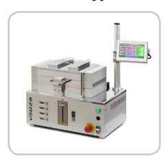
В печи VSU28 ИК-лампы расположены под нагревательной плитой и (опционально) над ней. Плита имеет прямоугольную форму размерами 260 х 210 мм и может быть выполнена из любого материала, соответствующего требованиям процесса, например, гранита. В плите могут быть предусмотрены отверстия для того, чтобы закрепить на ней изделия и необходимую оснастку. Конструкция печи позволяет размещать в ней плиту с предустановленными изделиями, что удобно для серийного производства.
