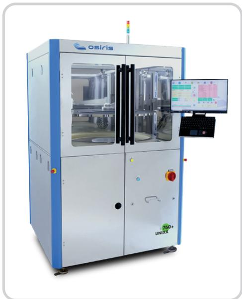
Полуавтоматическая автономная установка UNIXX S 760+ предназначена для нанесения покрытий методом центрифугирования на крупноразмерные подложки. В установке применяется технология ССР (Covered Chuck Processor – центрифугирование с закрытой крышкой), позволяющей наносить покрытия с превосходной однородностью и повторяемостью.
