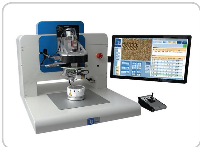
Автоматическая установка ТРТ HB100 предназначена для ультразвуковой микросварки тонких проволок из алюминия, золота, меди и серебра («клин-клин», «шарик-клин»); позволяет формировать отдельные бампы на поверхности микросварки. Управление установкой осуществляется с помощью сенсорного экрана и джойстика; выбор области микросварки и нацеливание инструмента — с помощью камеры высокого разрешения.
