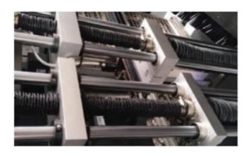
Конвейер из стальных роликов обеспечивает плавное движение. Фиксация платы осуществляется боковым зажимным устройством на пневмоцилиндрах.
