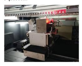
Три независимые секции конвейера с функцией автоматической регулировки ширины. Интерфейс SMEMA для встраивания в линию.
