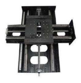
Легкая и прочная платформа из литого алюминия. Оси X/Y/Z оборудованы прецизионными ШВП и линейными направляющими, обеспечивающими точность позиционирования до +/-0,5 мм. Модуль полностью герметичный, подвижные части изолированы от взаимодействия с флюсом.
