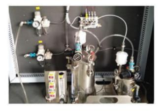
Струйный или аэрозольный клапаны для дозировки флюса. Размер точки флюса на плате - от 4 до 12 мм.
